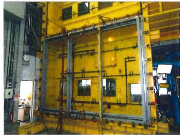
写真 16 試験時の状況 (+3.60kPa 時, 屋内側)
