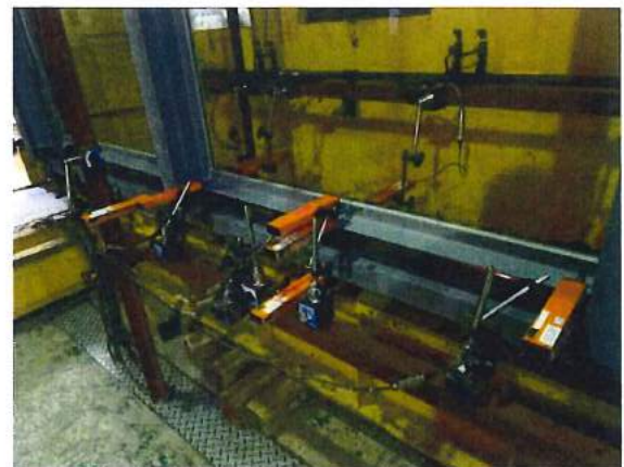
写真10 変位計設置状況 (試験体下部, 屋内側)
