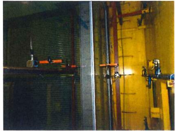
写真 14 変位計設置状況 (試験体中央部, 屋外側)
