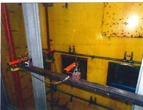
写真11 変位計設置状況 (試験体中央部, 屋内側)
