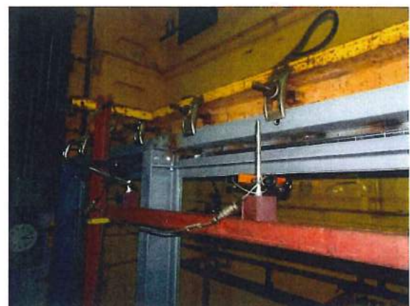
写真12 変位計設置状況 (試験体上部, 屋内側)
