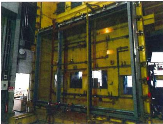
写真 17 試験時の状況 (-3.60kPa 時, 屋内側)
