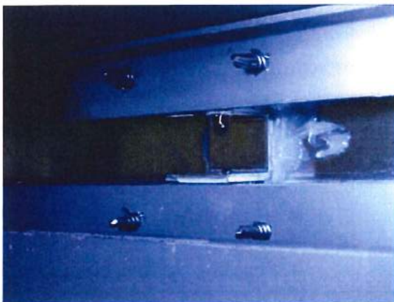
写真9 アルミ水切り突き合わせ部より にじみ出し (圧力中央値 500Pa, 上限値 750Pa)
